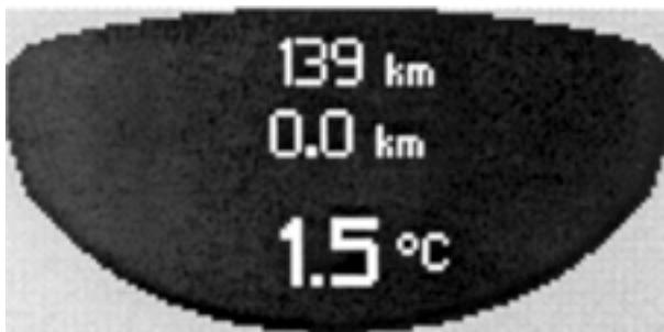
*Bild 5: Anzeige nach Einschalten der Zündung (Werkseinstellung). Gesamtwegstrecke, Tageswegstrecke, Bordcomputer. Die Werkseinstellung wird auch stets angezeigt nach Einschalten des Kombiinstrumentes und während einer Nachlaufzeit nach Abschalten der Zündung.*
