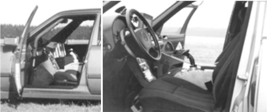
*Bild 3: Drive-by-wire Fahrzeuge Mercedes-Benz 300E (W124) und Mercedes-Benz S500 (W140) mit einem aktiven, programmierbaren Sidestick zwischen Fahrer- und Beifahrersitz*
