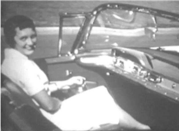
*Bild 1: Chevrolet Impala mit zweiachsigem federzentrierten Stellteil (unicontrol) zur Steuerung der Längs- und Querdynamik /Einzelbild aus 16mm-Film von J.B.BIDWELL/*
