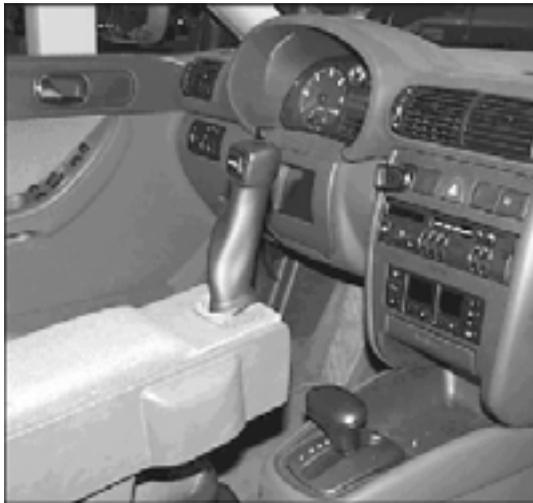
*Bild 6: Sidestick und modifiziertes Cockpit*
