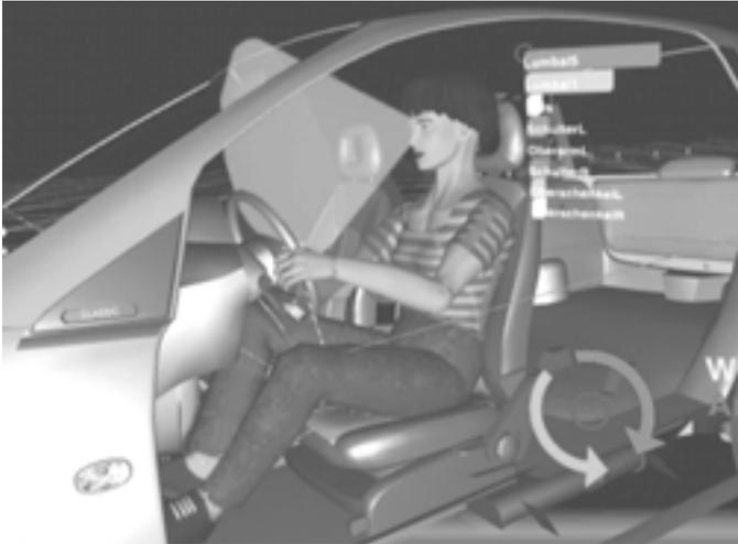
*Bild 6: Umsetzung der Kraftdiskomfortanalyse in Virtual Reality*
