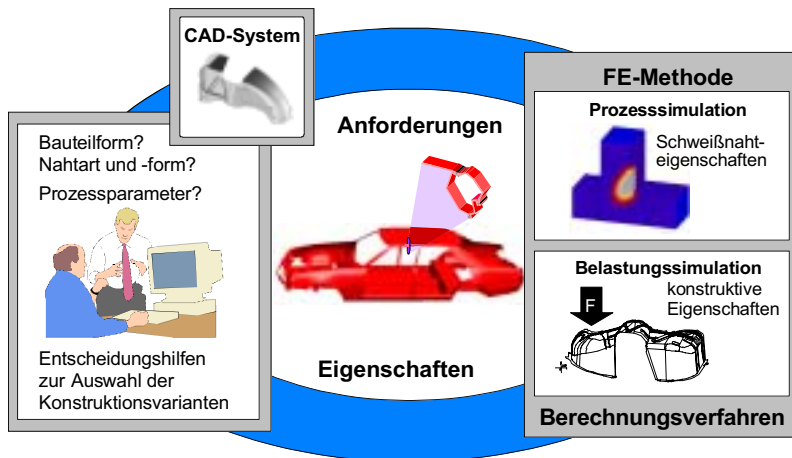
Bild 1.2: Untersuchung des Einflusses des Fertigungsprozesses auf die Produkteigenschaften durch Simulation von Schweißprozess und Lastfall
