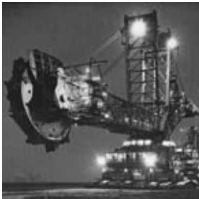
Abb. 1.1: Schaufelradbagger aus dem Tagebau
