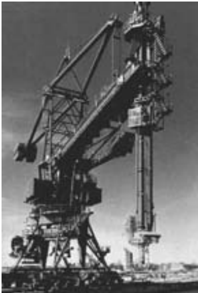
Abb. 1.3: Schiffsentlader mit Hochleistungs-Schneckenförderer
