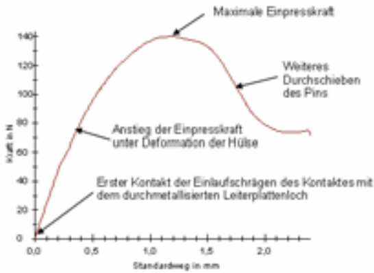
Abbildung 4.7: Kraft-Weg-Verlauf des Einpressvorganges
