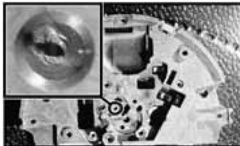
Abbildung 64: Beschädigung eines Lagers des Uhrwerksträgers durch zu hohe Montagekräfte
