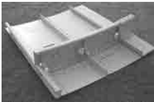
Abbildung 42: Segment einer Rumpfschale, gefertigt in klassischer Nietbauweise (STARON et al. 2007)
