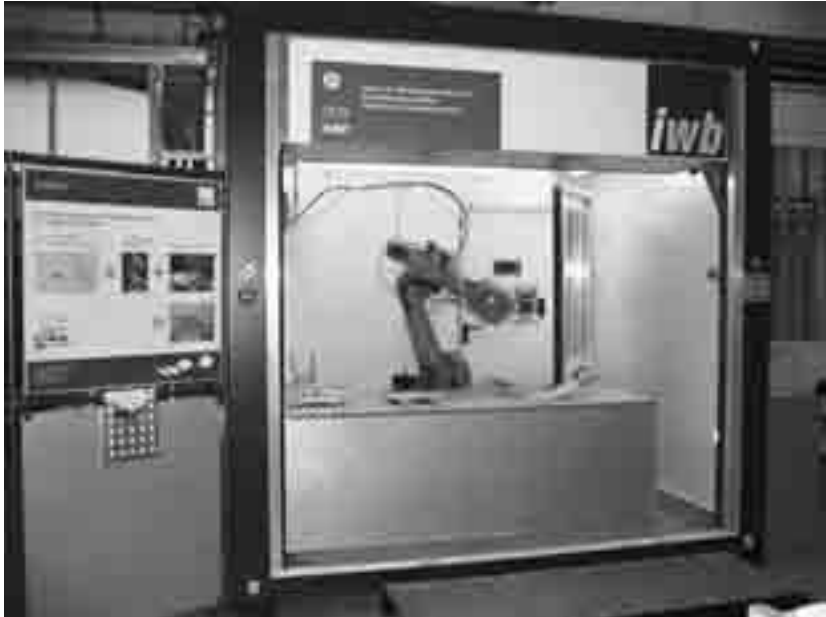
Abbildung 24: Experimenteller Aufbau zum Laserstrahlbiegen
