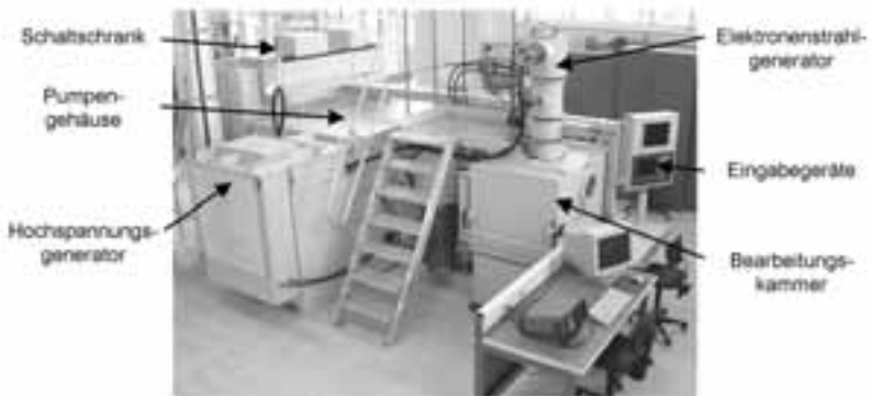
Abbildung 22: Elektronenstrahl-Schweißanlage im Versuchsfeld des iw (Insitut für Werkzeugmaschinen und Betriebswissenschaften der TU München)
