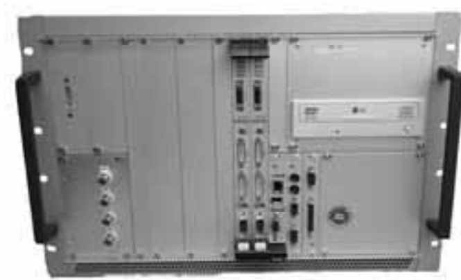
Bild 6.1. Echtzeit-Bildverarbeitungssystem auf Basis eines hema CVS power-Systems.
