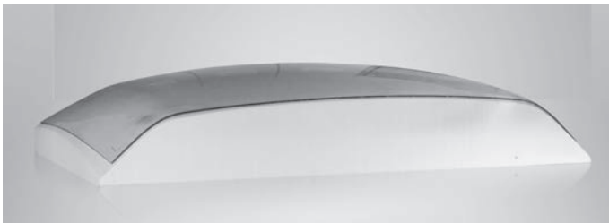
Abbildung 1.3: Im Überlegverfahren umgeformte Scheibe aus PMMA auf einer Form aus PU-Schaum
