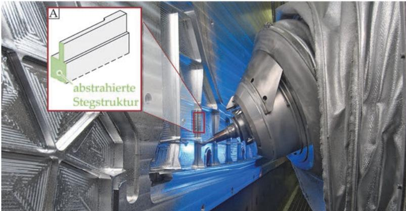
Abbildung 1.1: Fräsbearbeitung einer dünnwandigen Flugzeug-Strukturkomponente (Integralbauteil) (Bildquelle: AEROTEC (2016))
