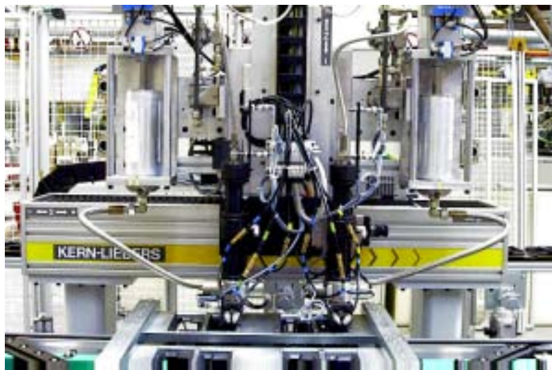
Abbildung 1-4: Kartesische Auftragsanlage für viskose Klebdichtstoffe [Hugo Kern & Liebers GmbH]
