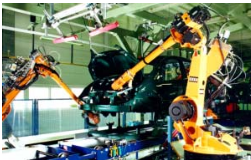
Abbildung 1-5: Sechsen-Knickarm-Roboter; Nahtabdichtung [Kuka Roboter GmbH]
