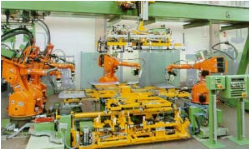
Abbildung 1-6: Sechssachsen-Knickarm-Roboter; Dichtraupenauftrag auf Windschutzscheiben [Quelle: Kuka Roboter GmbH]
