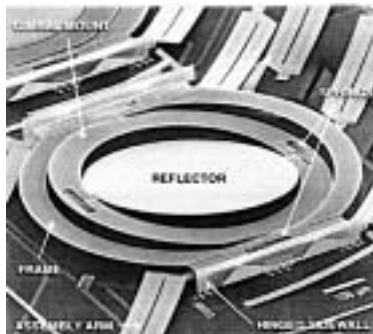
Abb. 1-2: Mikrospiegelarray für die optische Telekommunikation (Quelle: Lucent Technologies)
