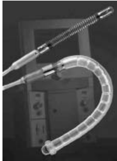
Abb. 1-1: Pumpe zur Unterstützung der Herztätigkeit während Operationen (Quelle: Impella)
