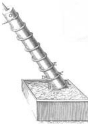
Bild 1: Archimedische Schraube (links, aus [OZANAM 1691]) und Nachbau einer industriellen Fertigungshalle Anfang des 19. Jahrhunderts mit Maschinen, die über eine gemeinsame Welle angetrieben werden (rechts, aus [DEUTSCHES MUSEUM 2005])
