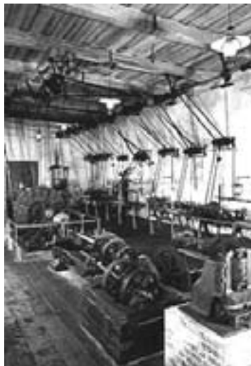
Bild 1: Archimedische Schraube (links, aus [OZANAM 1691]) und Nachbau einer industriellen Fertigungshalle Anfang des 19. Jahrhunderts mit Maschinen, die über eine gemeinsame Welle angetrieben werden (rechts, aus [DEUTSCHES MUSEUM 2005])
