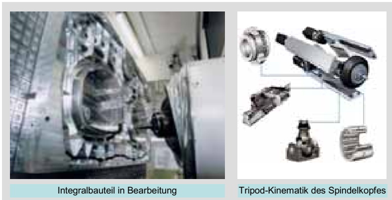
Abb. 1-1: Beispiel eines Maschinenkonzepts zur hochproduktiven Bearbeitung von Integralbauteilen für den Flugzeugbau [DS Technologie (2003)]
