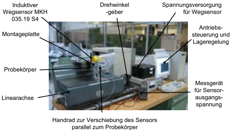
Abbildung 9–2: Versuchsaufbau zur Linearisierung der Wegsensoren auf einer Linearachse; Messung an Stahlformteilen mit den Abmessungen 19,4 \times 0,85 \text{ mm} sowie 21,7 \times 2,0 \text{ mm} .
