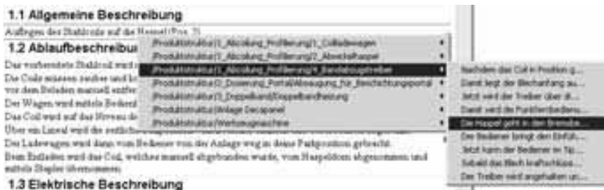
Abbildung 33: Modul und ordnerunabhängige Verknüpfung eines Objektes in DOORS am Beispiel einer Anlage für die Herstellung von Bauelementen
