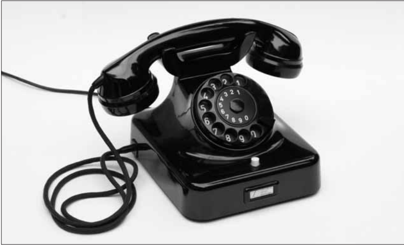
Bild 1: Tischfernsprecher 9Fgtist 5b (DBP-Name W 48 m.T.), 1948–ca. 1964
