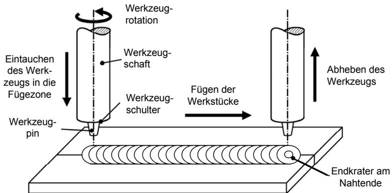
Abbildung 1-1: Schematische Darstellung des Prozessablaufs beim Rührreibschweißen (nach EIRENER 2006)
