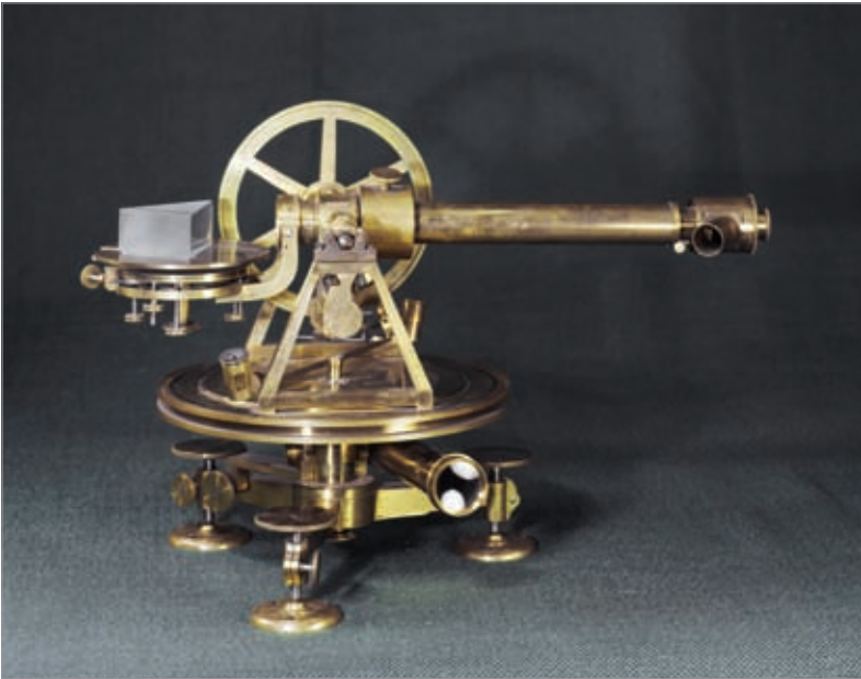
Abbildung 69: Prismenspektralapparat, um 1815 von Joseph von Fraunhofer, mit dem die „Fraunhoferschen Linien“ ausgemessen wurden. Photo: Deutsches Museum, 28819.
