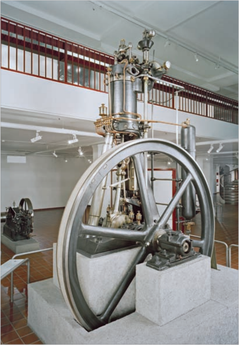
Abbildung 73: Erster Dieselmotor 1897. Photo: Deutsches Museum, BN 26448.
